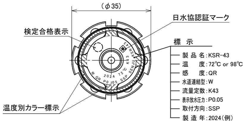
(注意)ヘッド相互の設置間隔:放水圧力0.7MPa以上かつ被水防止板を使用しない場合は3.3m以上離してください。
