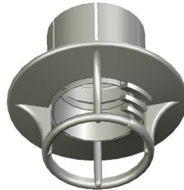
図2. ガードZNⅢに被水防止板を取付けた状態
