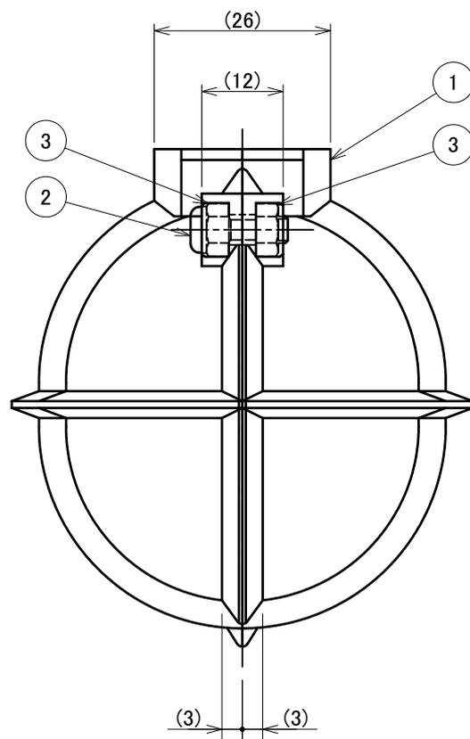
※半割り形状となっていますので、本製品をスプリンクラーヘッド(レンチ掛け部)に挟み込み、2個の十字穴付なべ小ねじで固定してください。
