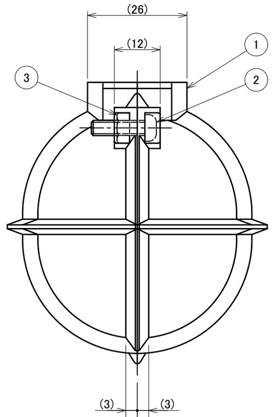
※半割り形状となっていますので、本製品をスプリンクラーヘッド(レンチ掛け部)に挟み込み、2個の十字穴付なべ小ねじで固定してください。
