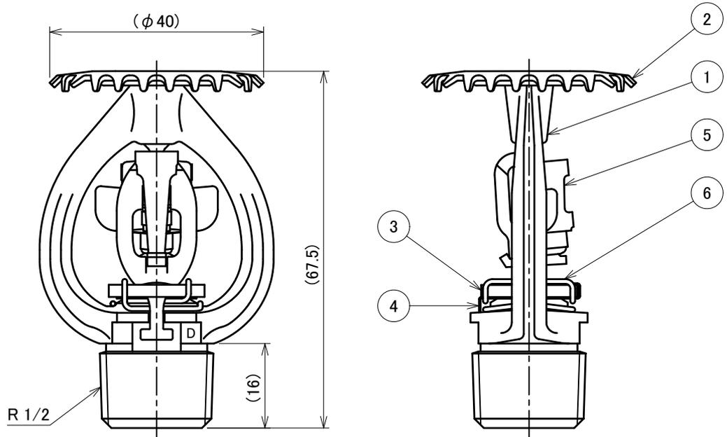
(一社)日本消火装置工業会が定める自主基準(負圧環境下でも使用可能なヘッドの試験基準)に基づき性能が確認されたヘッドです。
