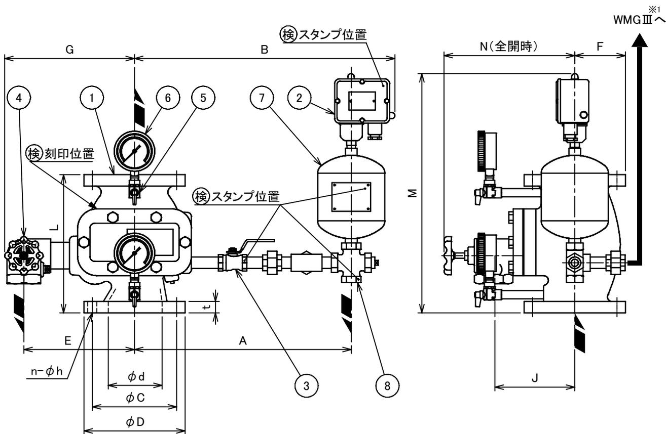
※1.ウォーターモーターゴング WMGⅢ型: 管径入口 20A、出口 25A。
