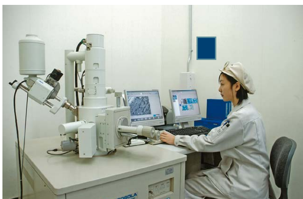
電子顕微鏡による材質検査
