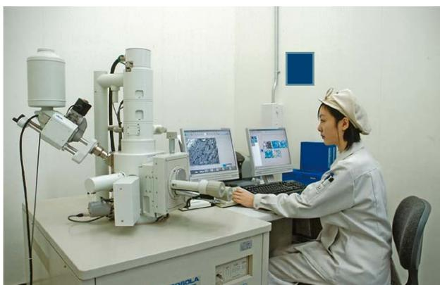
電子顕微鏡による材質検査
